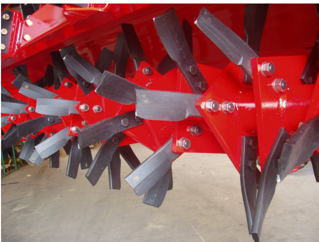
Gerade Messer mit 2 Schrauben befestigt
