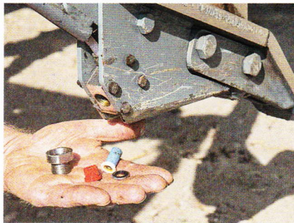
Zur Fermenteinspritzung befinden sich Standarddüsen in einem Edelstahlgehäuse.
