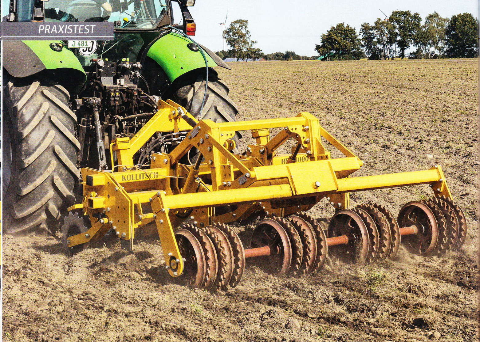
Der Kollitsch HBL 3000 hebt den Boden auf 3 m Breite an, ohne ihn zu bearbeiten und hinterlässt eine annähernd ebene Oberfläche. Fotos: Holtmann
